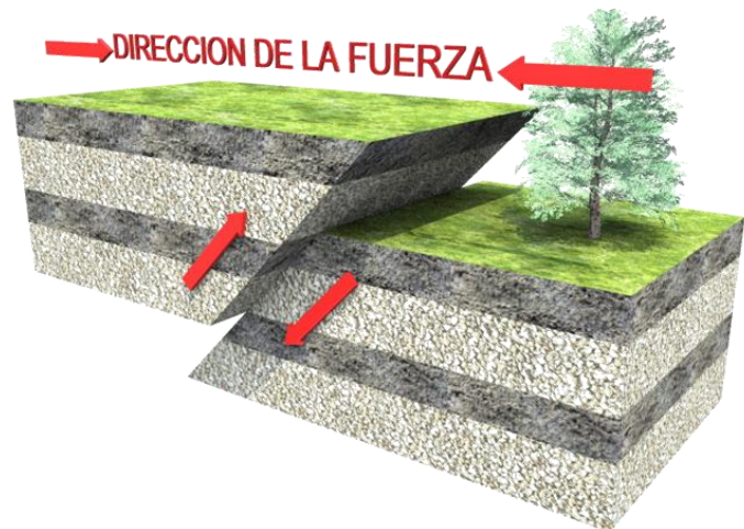
Imagen 48 Ejeción de falla local/ Falla inversa o de compresión // Fuente: INETERmplifica
