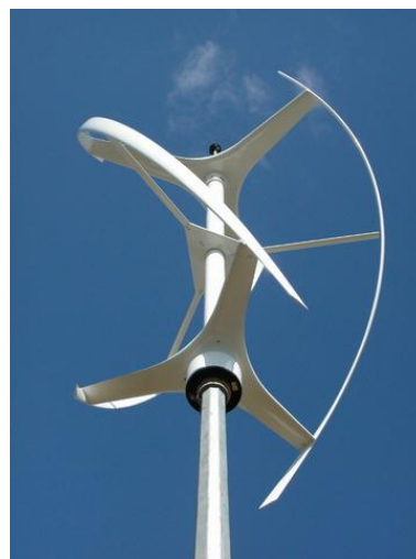
IMAGEN 69 Turbina eólica de eje vertical tipo DARRIEUS // FUENTE: Propia
