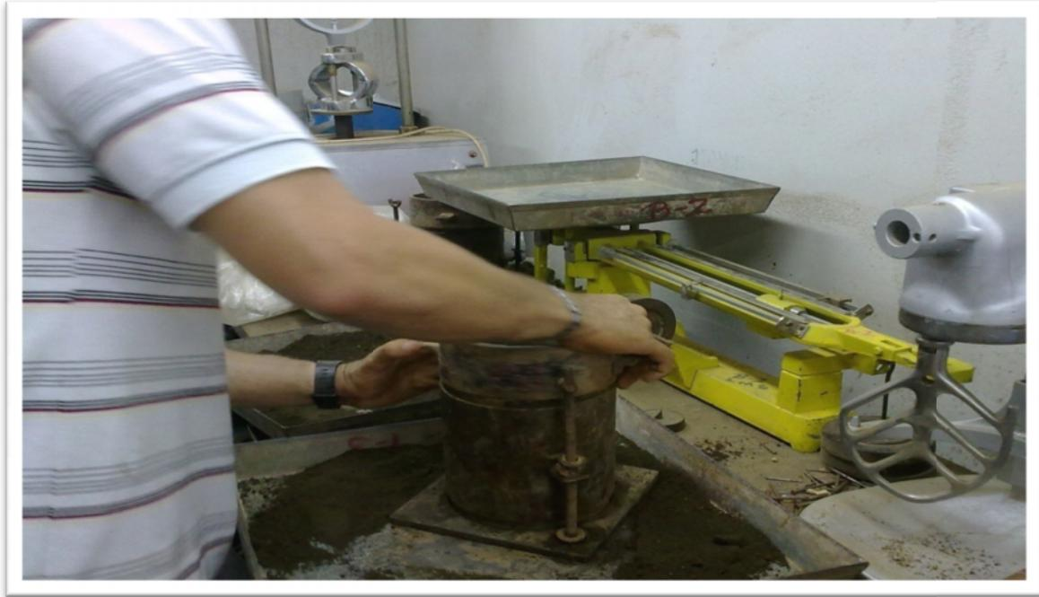
Ensaye de CBR, compactación del material para su posterior saturación (basada en las normas ASTM D 1883-73; AASHTO T 193-63)
