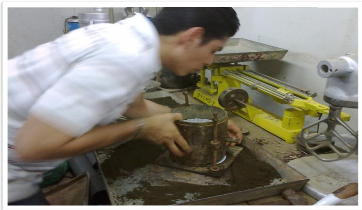
Ensayo de compactación a grupos de muestras (basada en las normas ASTM D 1557-91; AASHTO T 180-90)
