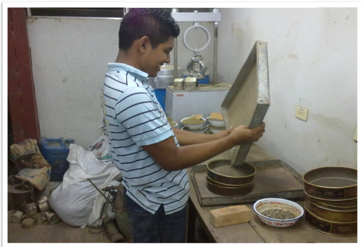
Ensaye de análisis granulométrico para determinar el tamaño de las partículas (basada en las normas ASTM D-422; AASHTO T 27-88)
