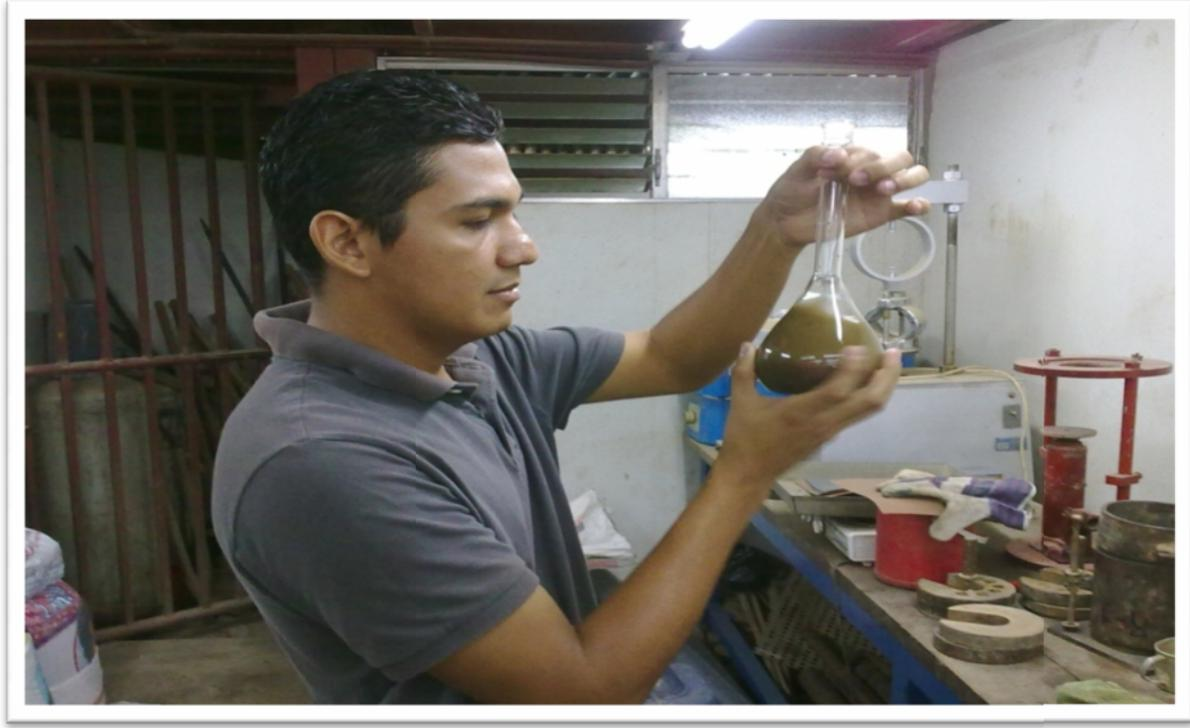
Ensayo de gravedad especifica de los suelos (basada en las normas ASTM D-558; AASHTO T 93-86)
