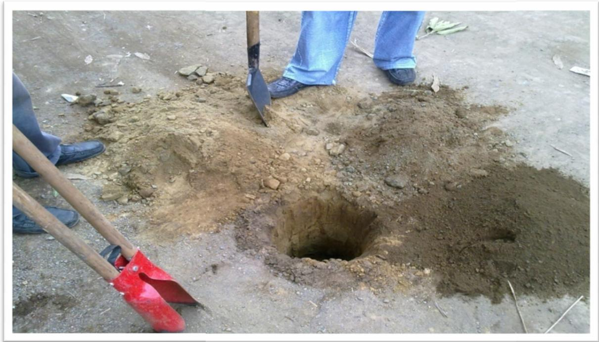
Extracción de muestras en el campo (método: sondeo manual/ cada 150 metros de distancia, 1.2 m de profundidad, 15 cm de diámetro)
