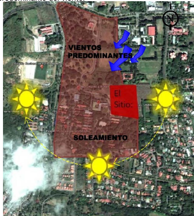
Figura No. 62. Simulación del recorrido solar y dirección predominante del viento.
