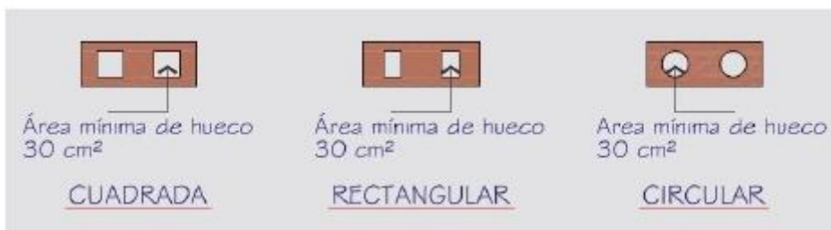
Ilustración N° 3. Área mínima de huecos para la mampostería reforzada interiormente.
