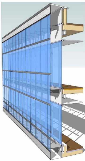
Ilustración No. 46 Detalle de vidrio aislante acústico para muro cortina.
