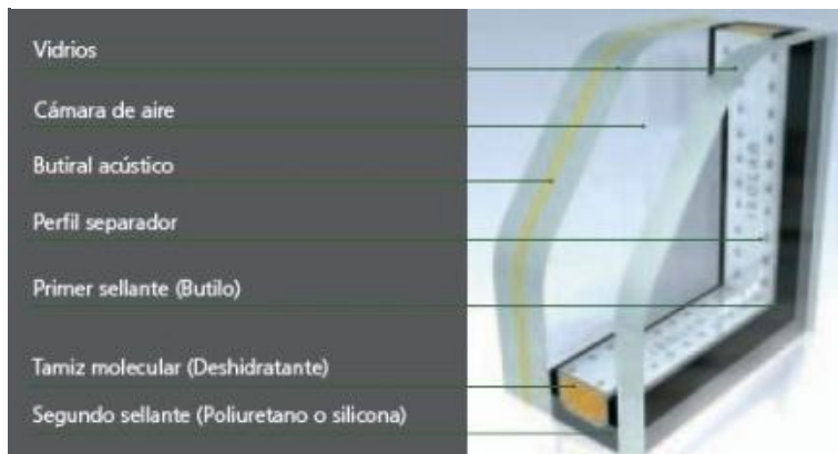
Ilustración No. 46 Detalle de vidrio aislante acústico para muro cortina.
