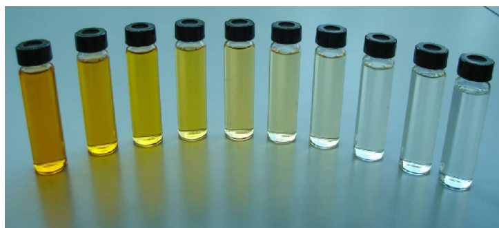
Rys. 4.12. Zmiana zabarwienia roztworu oranżu metylowego, spowodowana działaniem fotokatalitycznym nanocząstek dwutlenku tytanu. Czas między pobieraniem kolejnych próbek wynosił 30 minut
