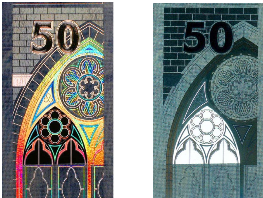
Rys. 7. 15. Elementy wykonane technologią kinegram zero.zero na folii STRAP Perfection. Po lewej – w świetle odbitym, po prawej – w przechodzącym, uwidaczniającym przezroczyste okienka folii
