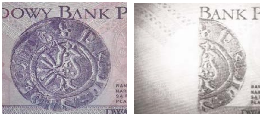
Rys. 3.5. Fragment rewersu banknotu o nominale 20 zł wydrukowany parą farb metamerycznych; w świetle odbitym (po lewej) oraz w świetle podczerwonym (po prawej) oglądany przez infraskop – jedna z farb staje się niewidoczna Źródło: Luśnia T., Przegląd wybranych farb specjalnych stosowanych do produkcji dokumentów. Problemy Kryminalistyki 247/05, s. 35-39.
