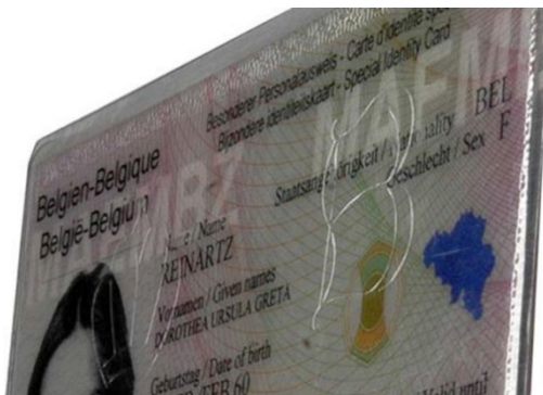
Rys. 10.8. Litera B wytoczona w laminacie
