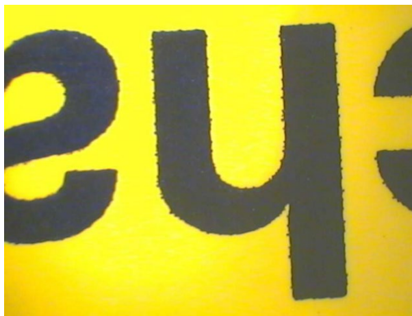
Rys. 5.10. Nadruk wykonywany sitodrukiem
