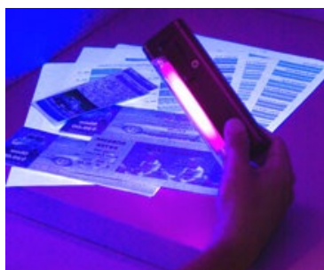
Rys. 6.3. Weryfikacja nadruku wykonanego technologią Fluorescent Mark™
