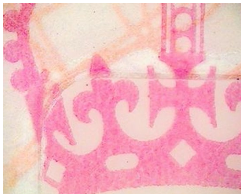
Rys. 5.11. Nadruk fleksograficzny na laminacie
