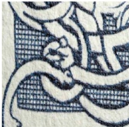
Rys. 5.4. Nadruk wykonany techniką stalorytniczą (Islandia – paszport)
