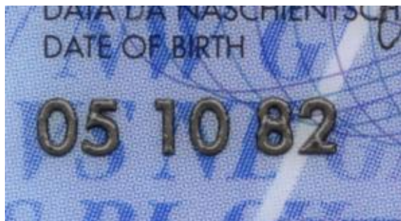
Rys. 10.25. Wyczuwalna dotykowo laserowo wygrawerowana data urodzenia
