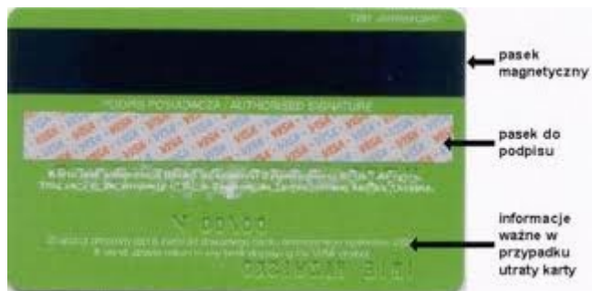
Rys. 3.19. Pasek magnetyczny karty kredytowej
