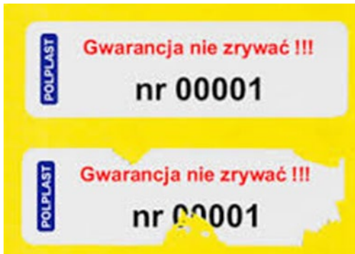
Rys. 9.1. Plomby ulegające destrukcji podczas zrywania
