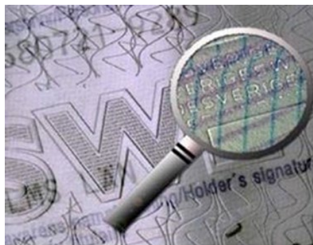
Rys. 10.11. Mikrodrukowe wytłoczenia w laminacie Źródło: http://prado.consilium.europa.eu/PL/glossaryPopup_files/image098.jpg (11.12.2014).
