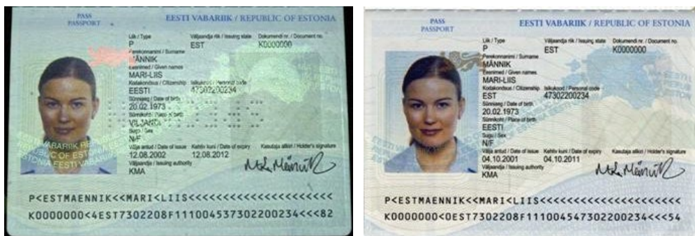
Rys. 3.9. W estońskim paszporcie na stronie personalizowanej wykonany jest nadruk opalizującą farbą fotochromową. Pod wpływem naświetlenia promieniowaniem UV zielonkawy nadruk, po usunięciu źródła światła UV, przez pewien czas pozostaje niebieski (strona przed naświetleniem promieniowaniem UV – po lewej, po naświetlaniu – po prawej) Źródło: http://prado.consilium.europa.eu/PL/glossaryPopup_files/image047.jpg ; http://prado.consilium.europa.eu/PL/glossaryPopup_files/image048.jpg (21.11.2014).
