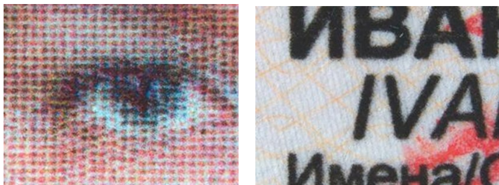
Rys. 5.17. Integracja danych personalnych (wizerunku) podpisu z podłożem oraz powiększony nadruk wykonany metodą elektrofotografii
