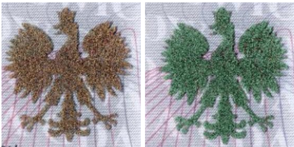
Rys. 3.15. Farbą zmienną optycznie został nadrukowany orzeł na polskim dowodzie osobistym
