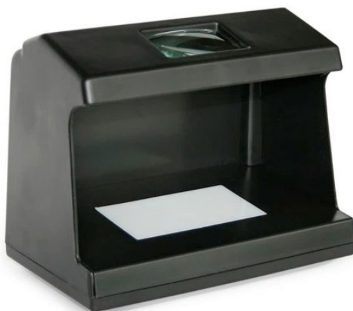
Rys. 11.1. Tester banknotów Wallner DL-1011. Wyposażenie: świetlówka UV (9 W) do sprawdzania elementów widocznych w ultrafiolecie; świetlówka biała (4 W) do sprawdzania znaków wodnych; szkło powiększające do odczytywania mikrodruków Źródło: http://ebiurowe.com.pl/tester-banknotow-wallner-dl1011-p-521.html (20.12.2014).
