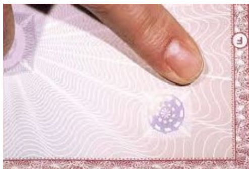
Rys. 3.11. Wywołanie farby termochromowej na blankiecie zabezpieczonej akcji
