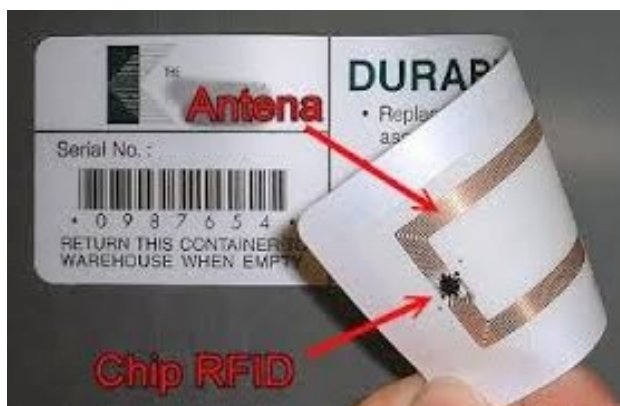
Rys. 10.1. Etykieta samoprzylepna z chipem RFID
