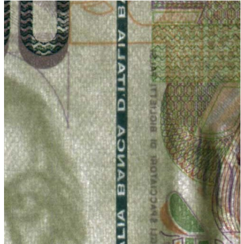
Rys. 2.17. Nitka zabezpieczająca z mikrodrukiem w świetle przechodzącym
