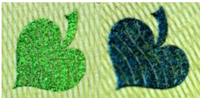
Rys. 3.16. Przykład elementu nadrukowanego farbą OVI – paszport Republika Czeska Źródło: – http://consilium.europa.eu/prado/PL/glossaryPopup_files/image052.jpg (3.01.2009).
