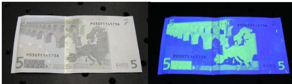
Rys. 3.1. Rewers banknotu 5 euro w świetle normalnym (po lewej) oraz w świetle UV (po prawej), jako przykład farby fluorescencyjnej
