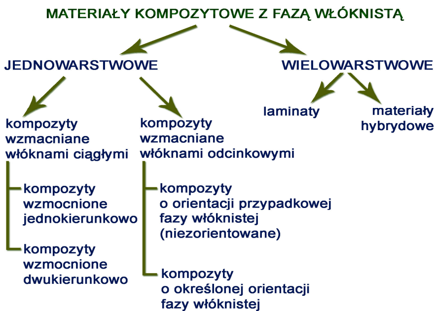
Rysunek 2.4. Rodzaje kompozytów polimerowych wzmocnianych fazą włóknistą
