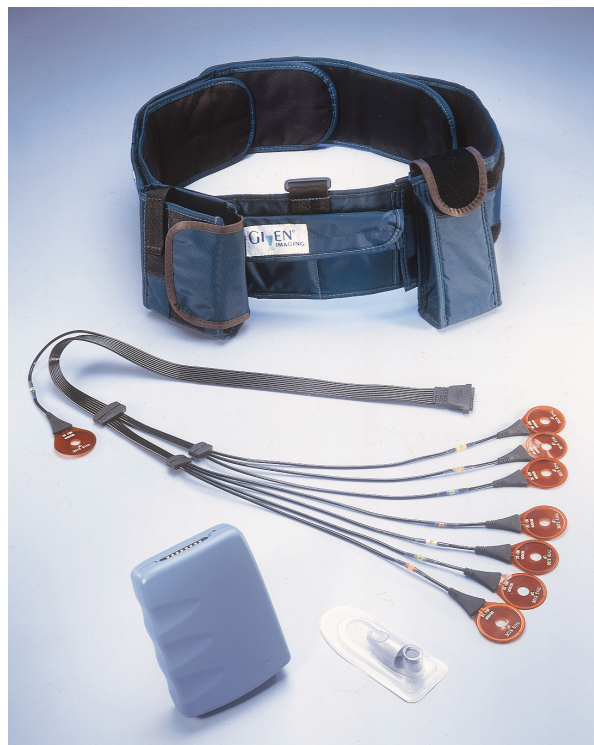
Rys. 2.2. Elementy systemu endoskopii bezprzewodowej: pas biodrowy, zestaw anten, odbiornik-rejestrator i kapsułka w opakowaniu (ilustracja udostępniona przez firmę GivenImaging )
