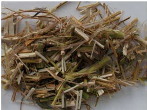
Zdjęcie 1. Biomasa wyściowa – słoma konopna (odcinki 5 cm)
