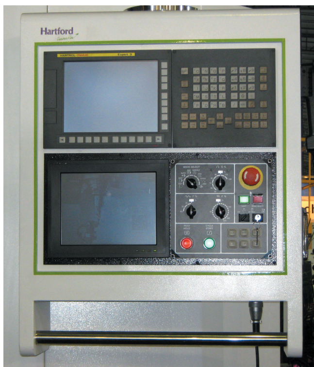
Rys. 9. Panel sterowania z dwoma monitorami wykorzystany w centrum obróbkowym HSA 323EA firmy HARTFORD
