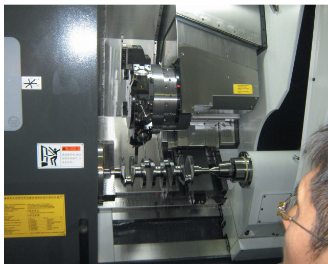
Rys. 11. Obróbka wału korbowego na wielozadaniowej obrabiarence firmy GOODWAY
