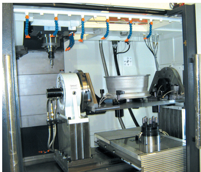
Rys. 13. Obróbka felg aluminiowych na linii produkcyjnej CHEVALIER
