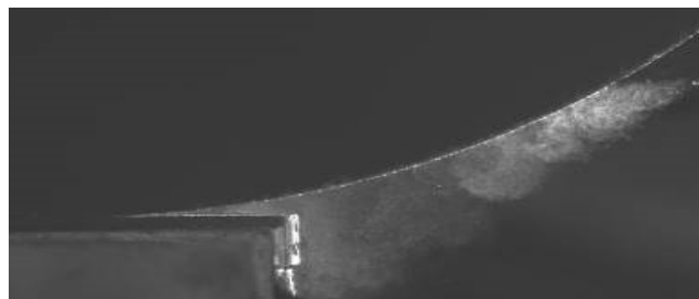
Rys. 1 Rozpylona mgła olejowa (MQL) w strefie szlifowania [10]
