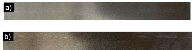
Rys. 8. Widok powierzchni próbki: a) przy szlifowaniu z prędkością v_{s1} = 17 m/s, b) przy szlifowaniu z prędkością v_{s2} = 24 m/s na której zaobserwowano przypalenia powierzchniowe warstwy wierzchniej.
