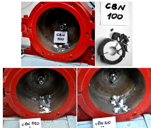
Rys.6. Zniszczenie ściernicy w wyniku rozerwania
