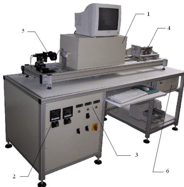
Rys. 1. Widok ogólny zautomatyzowanego stanowiska do pomiarów napięcia powierzchniowego i kątów zwilżania: 1 - wysokotemperaturowy dwustrefowy piec elektryczny; 2 - precyzyjny system kaskadowej programowej regulacji temperatury; 3 - układ zasilania gazami technologicznymi; 4 - system załadowczo-wyładowczy próbki; 5 - kamera CCD; 6 - komputer sterującym procesem pomiarowym
