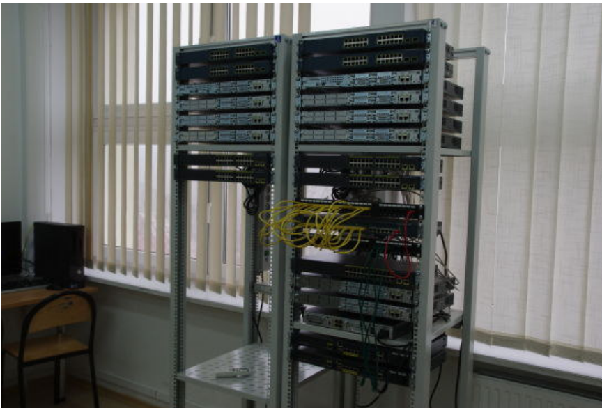
Rys. 4. Pracownia sieci komputerowych. Posiadany w Katedrze Informatyki Stosowanej sprzęt Cisco pozwala na nauczanie sieci w aspektach organizacji infrastruktury sieci komputerowych, zagadnień przełączania, routingu oraz bezpieczeństwa sieci
