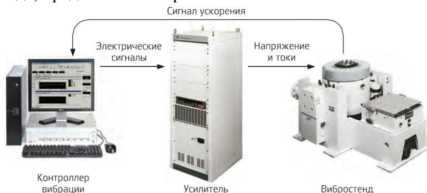
Рис. 1. Схема принципа действия вибростенда
