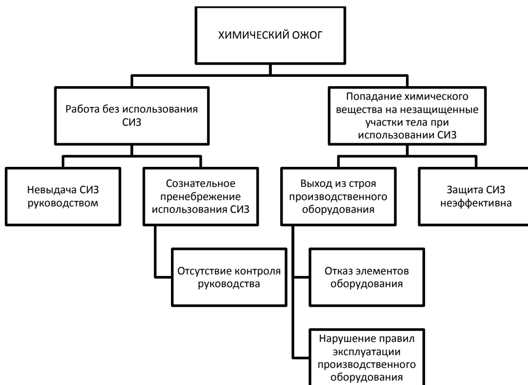
Рисунок 2 – «Дерево событий», приводящих к химическому ожогу при работе в химической лаборатории
