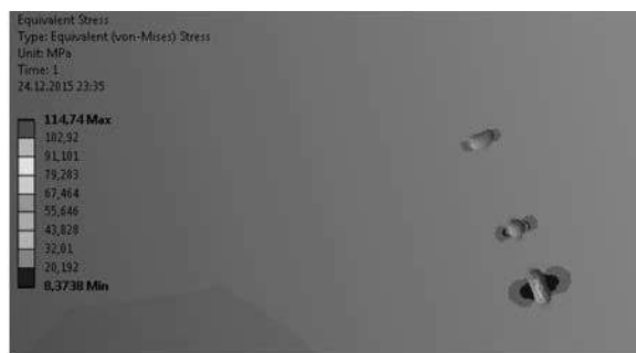
Рис. 2. Распределения напряжения фон Мизеса вокруг очагов различных направлений
