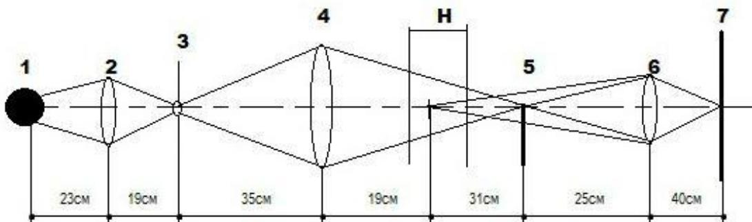
Рисунок 1. Схема Шлирен - метода
