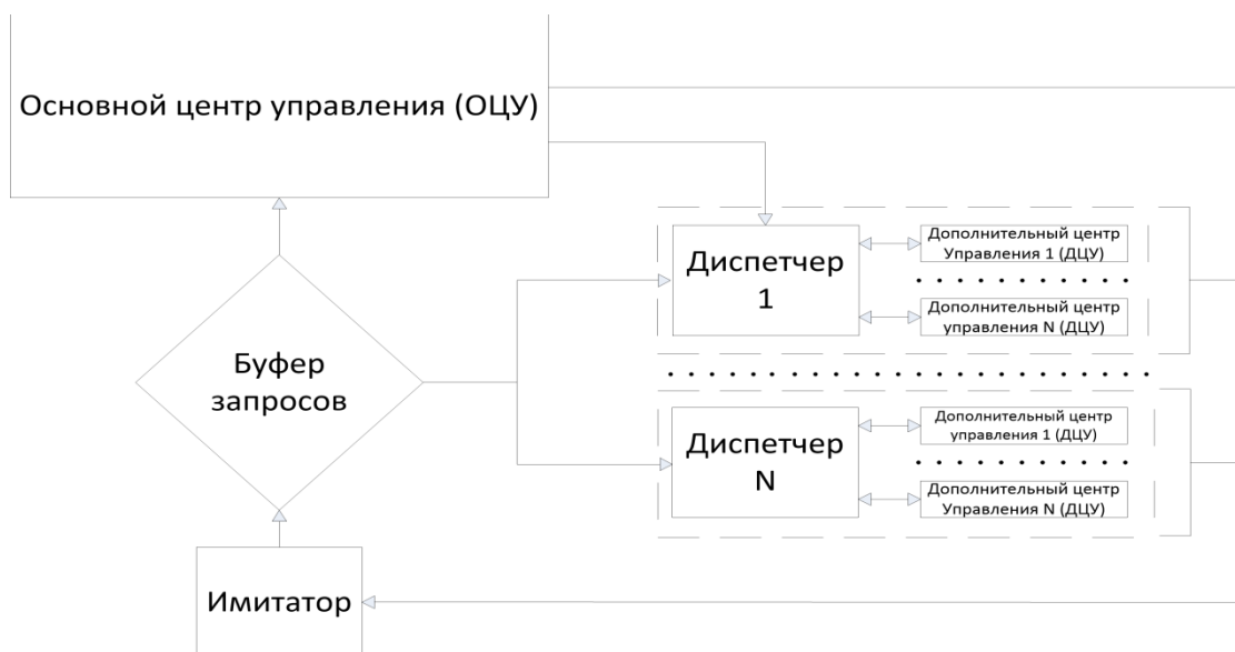
Рис. 1. Структурная схема моделируемой распределенной вычислительной системы
