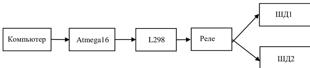
*Рисунок 1. Взаимосвязь элементов электронной части*
