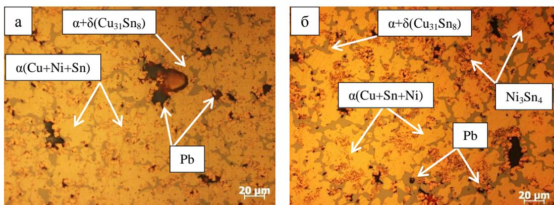
Рисунок 3 – Образец БрС10015Н5: а) при температуре 20°C б) выдержка 2 часа при температуре 300°C
