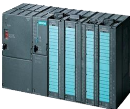
Рисунок 4 – Вид общий ПЛК Siemens SIMATIC S7-300
