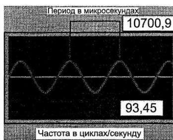
*Рисунок 11. Зависимость частоты колебаний от массы протекающей по ней жидкости (масса увеличивается период колебания растет частота колебания уменьшается)*
