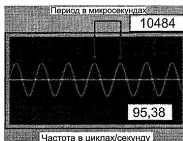
*Рисунок 12. Зависимость частоты колебаний от массы протекающей по ней жидкости (масса уменьшается период колебания уменьшается частота колебания растет)*
