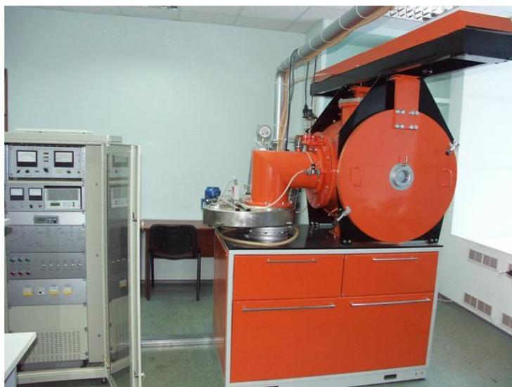
Рисунок 5 – Плазменная лабораторная установка КВО
