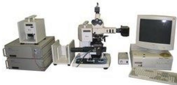
Рисунок 8 – Установка Micro-Scratch Tester MST-S-AX-000
