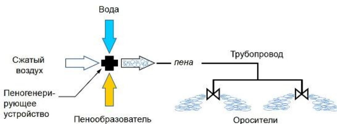
Рисунок 1 – генерирующее устройств с применением сжатого воздуха.
