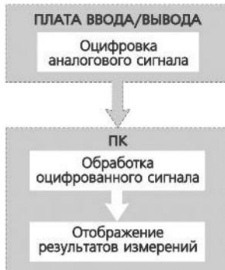
Рисунок 6.2 - Структурная схема виртуального прибора
