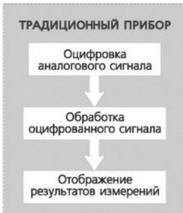
Рисунок 6.1 - Структурная схема автономного измерительного устройства
