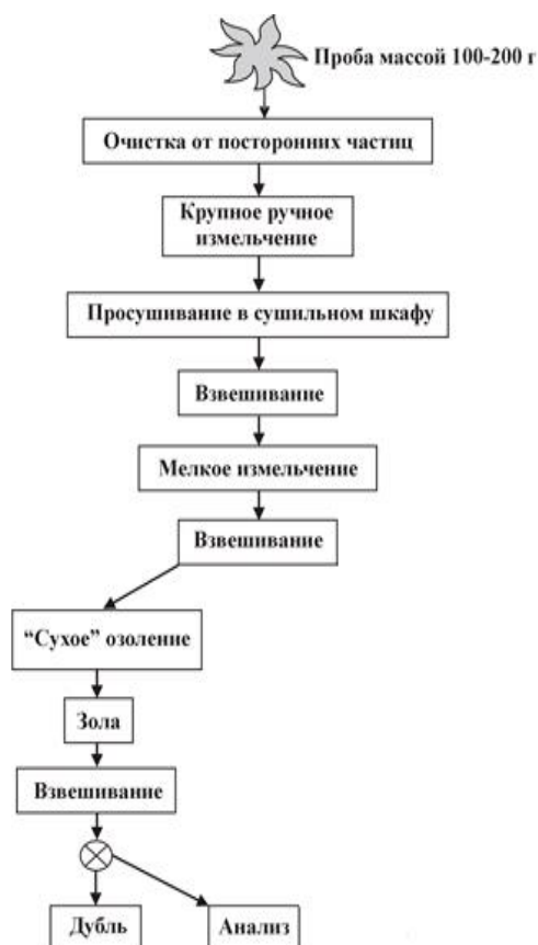
Рисунок 18 - Схема обработки и изучения проб растительности [46]
