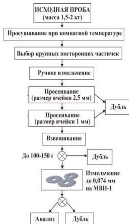
Рисунок 14 – Схема обработки анализа проб почв[47]
