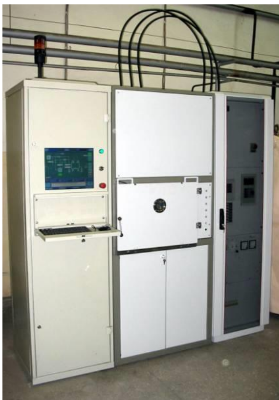
Рисунок 13 – Общий вид установки «СОЛО» для импульсной модификации поверхности металлов и сплавов, металлокерамических и керамических материалов электронным пучком
