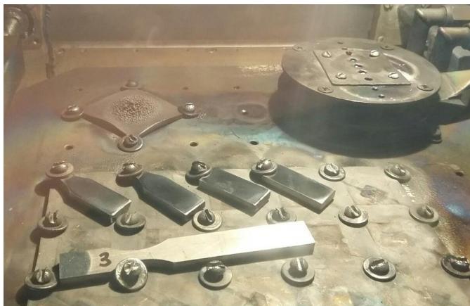
Рисунок 6 – образцы титана марки ВТ-6 в рабочей камере установки «СОЛО»
