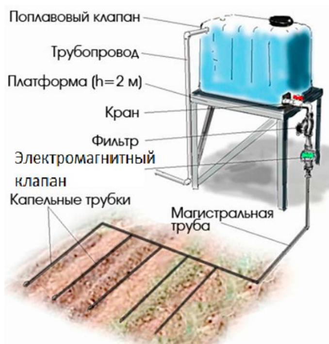
Рисунок 4 - Схема капельной системы автополива
