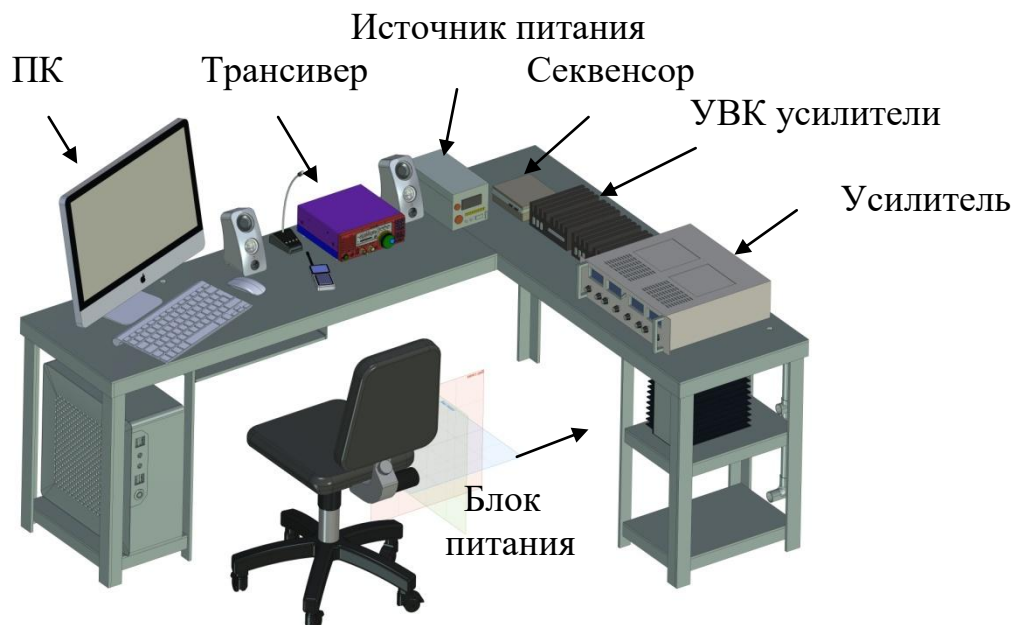
Рисунок 3 – Приемопередающее и управляющее оборудование станции
