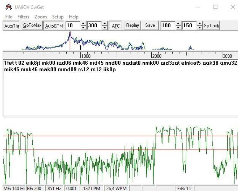
Рисунок 25 – CW-сигнал со спутника RS-12, обработанный в программе CwGet
