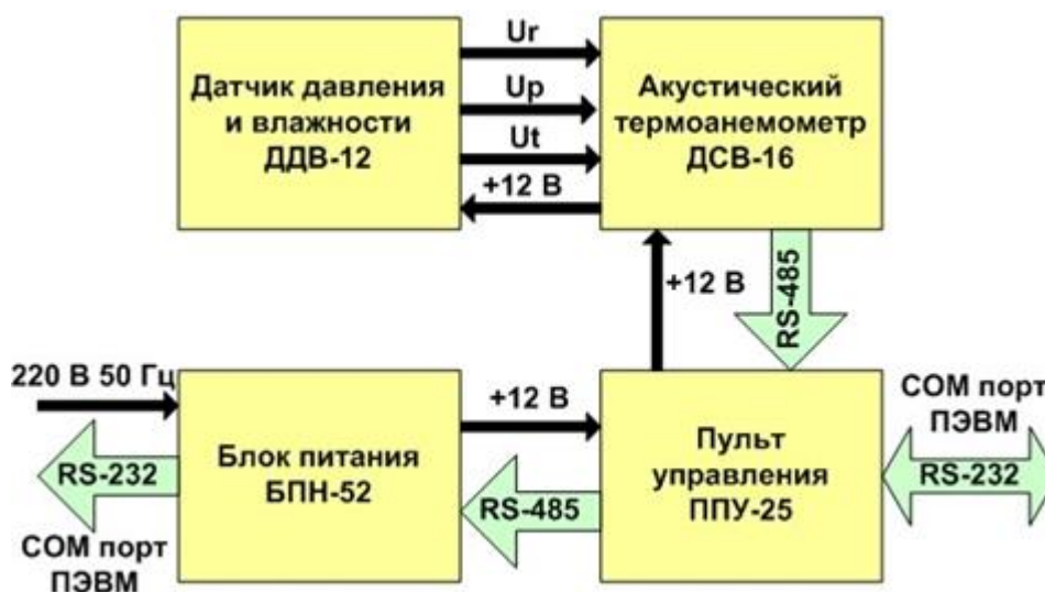
Рис.2.6. Структурная схема метеокомплекса АМК-03
