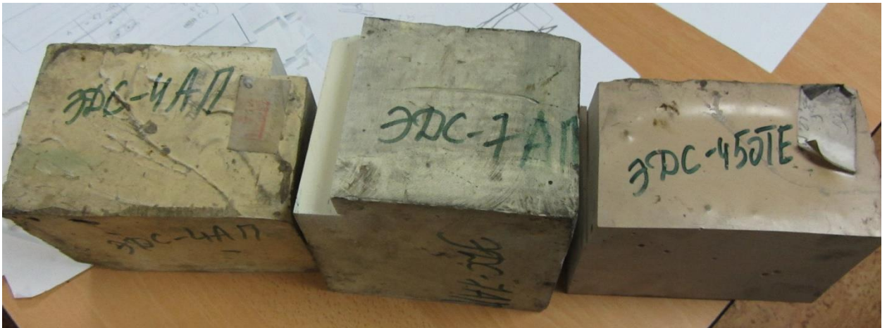
Рисунок 3.3 – Различные виды сферопластиков
