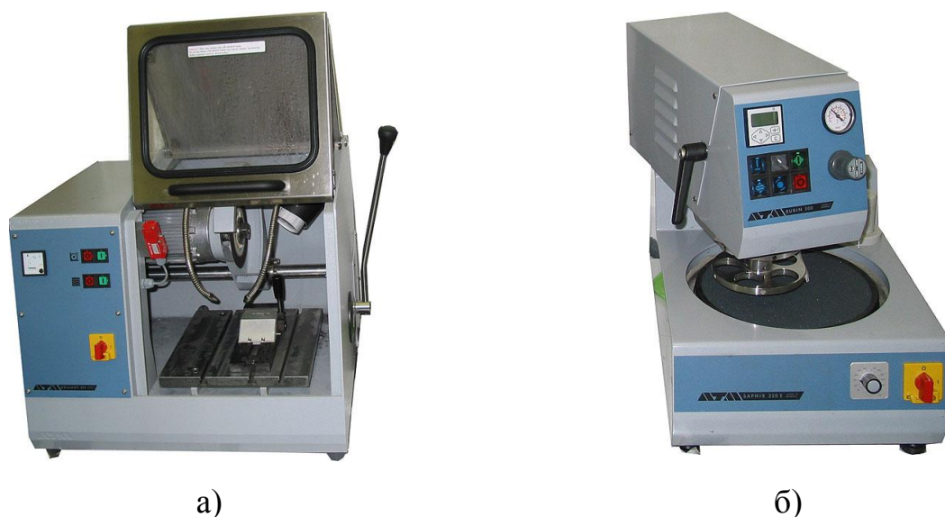
Рисунок 17 – Оборудование ЦИСМ для подготовки экспериментальных образцов: а) Отрезной станок АТА BRILLANT 201, б) Шлифовально-
