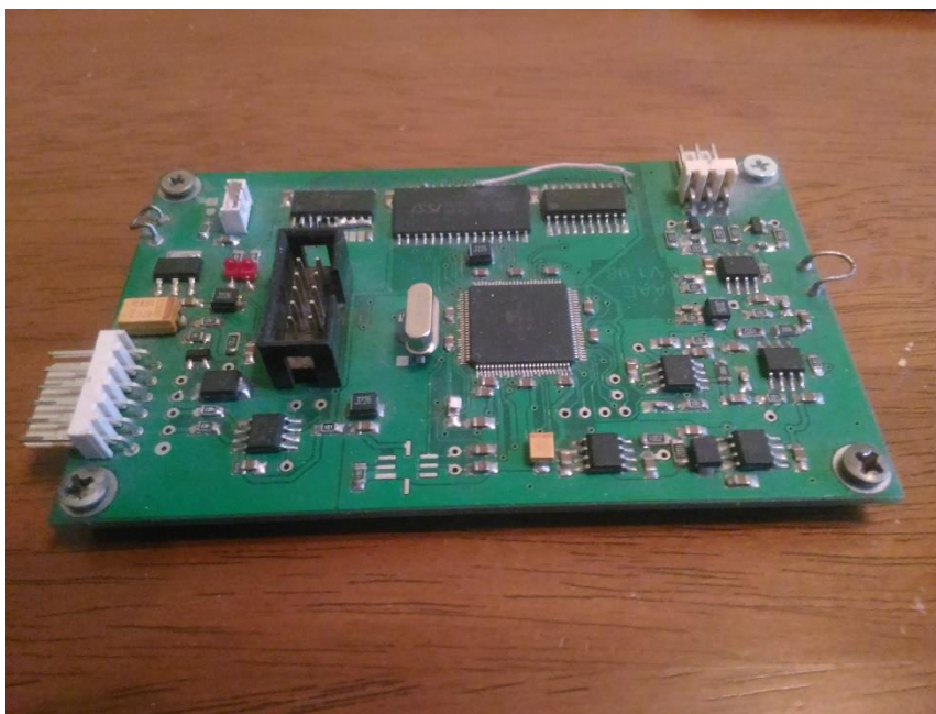
Рисунок 19 – Устройство мониторинга зданий методом акустической эмиссии Часть программного кода приведена в приложении В.
