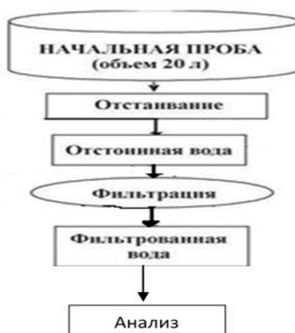
Рисунок 8. – Схема обработки и анализа проб подземных вод [21].
