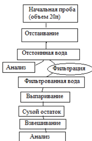
Рисунок 6 – Схема обработки и анализа водных проб[24]
