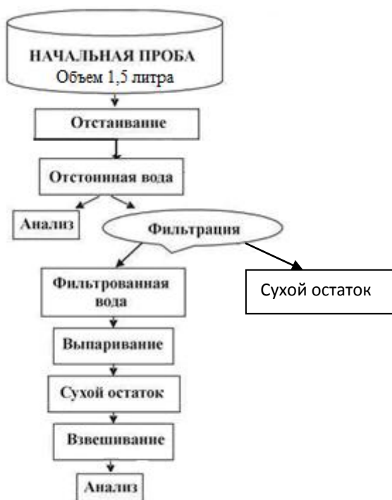
Рис. 5.2.4. Схема обработки и анализа водных проб [4]
