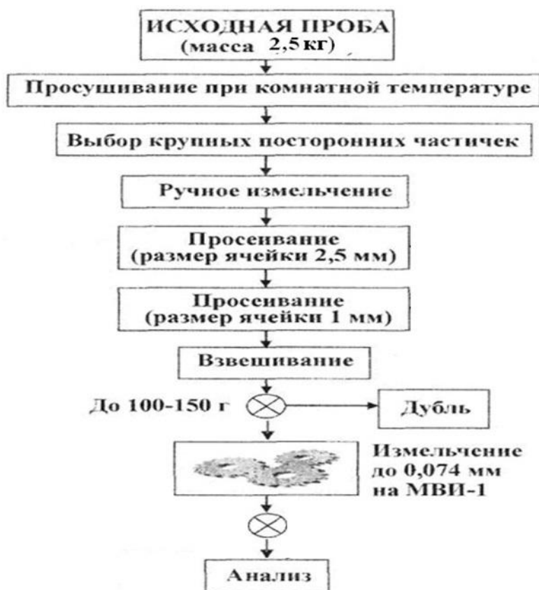
Рис. 5.4.2. Схема обработки и изучения проб почвы [4]
