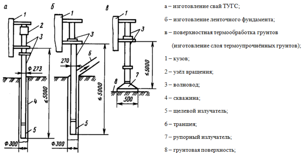
Рис. 8. Варианты обработки грунтовых массивов с использованием сменного оборудования мобильной СВЧ-установки
