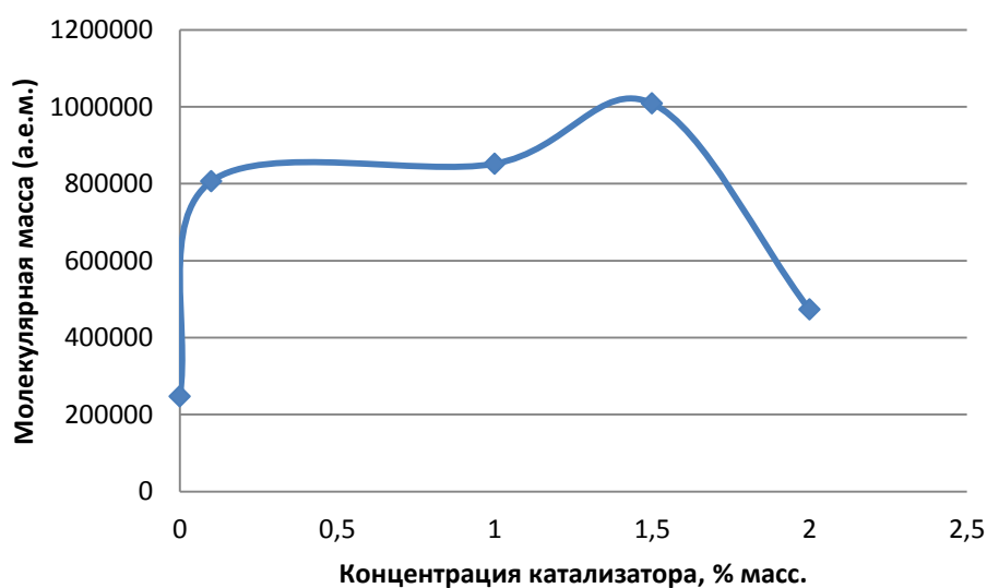
Рисунок 14 – Зависимость молекулярной массы полимера модифицированного лимонной кислотой от концентрации катализатора (октоата олова)
