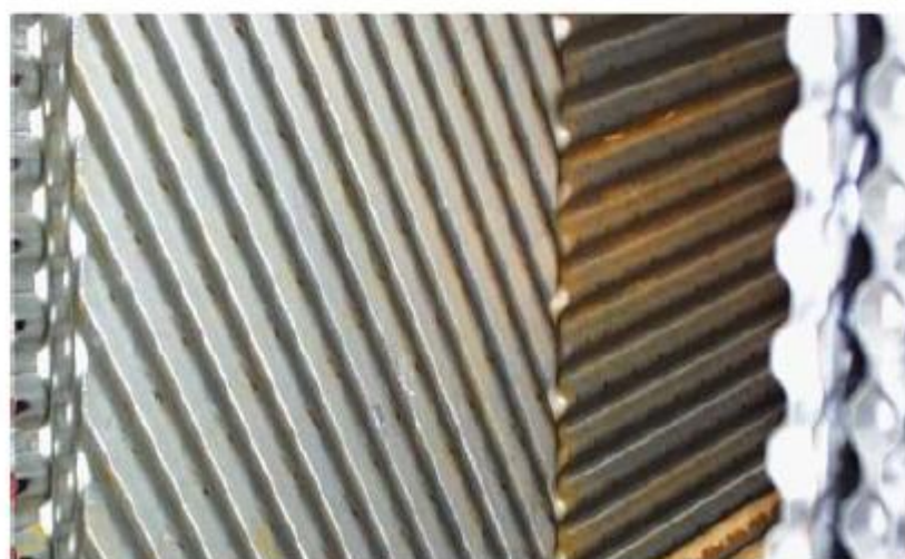
Рисунок 2. Фотографии поверхностей пластинчатых теплообменников: (а) до использования технологии (б) через 3 года эксплуатации после применения ПАВ-технологии
