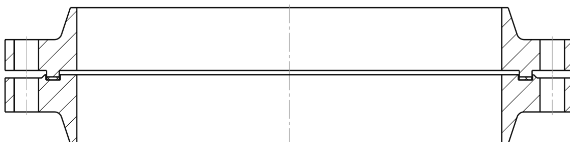
Рис. 3.3 - Соединение фланцев типа шип-паз. ГОСТ 28759.3-90
