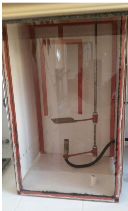
Рисунок 3.1 – Прибор для определения огнестойкости модификации ОТ-68 (ГОСТ 15898-70)
