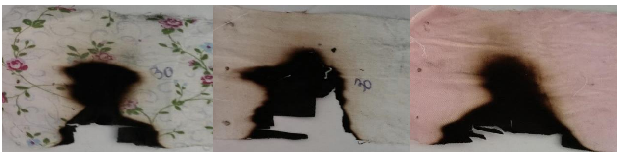
Рисунок 3.10 – Разрушение ТМ, пропитанных раствором 2, под воздействием открытого огня в течение 30 секунд
