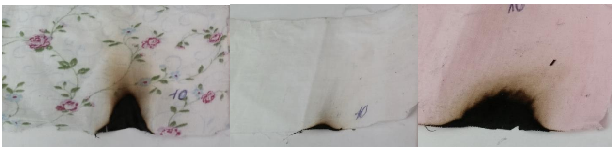
Рисунок 3.5 – Разрушение ТМ, пропитанных раствором 1, под воздействием открытого огня в течение 10 секунд
