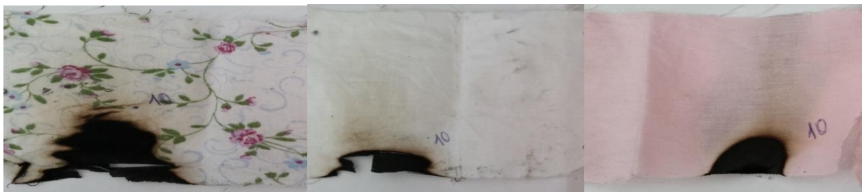
Рисунок 3.9 – Разрушение ТМ, пропитанных раствором 2, под воздействием открытого огня в течение 10 секунд
