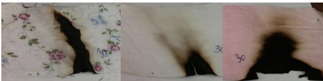
Рисунок 3.6 – Разрушение ТМ, пропитанных раствором 1, под воздействием открытого огня в течение 30 секунд
