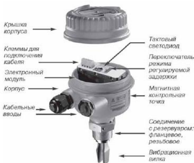
Рисунок 11 – Конструкция сигнализатора уровня жидкости Rosemount
