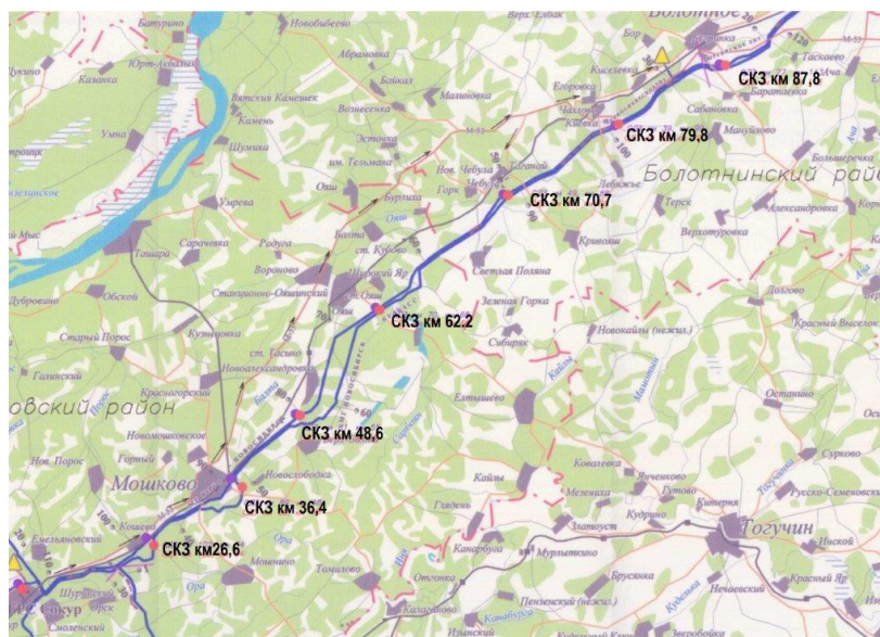
Рисунок 13. Схема расположения станций катодной защиты магистрального газопровода [REDACTED]
