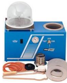
Рисунок 59. Вакуумная литьевая машина с вибростолом PRO-CRAFT 21.800GX
