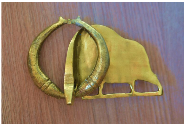
Рисунок 53. Изделие, полученное литьем по выплавляемым моделям и обработанное бор-машиной для получения полированной гладкой поверхности.
