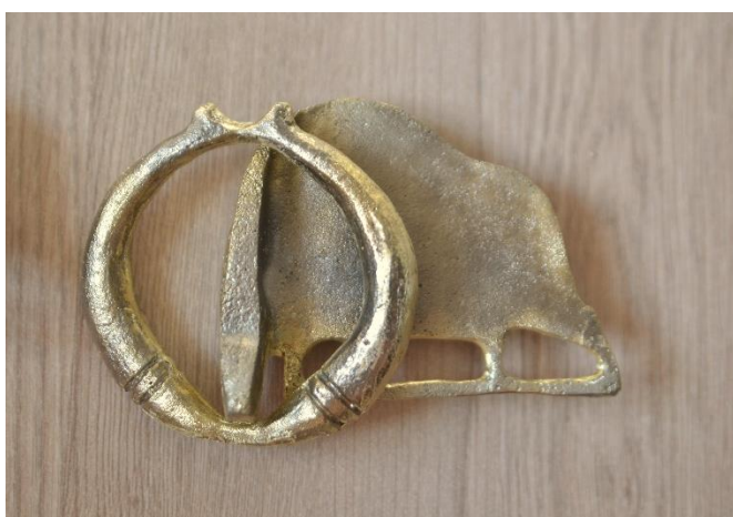
Рисунок 54. Изделие, изготовленное при помощи литья в землю, обработанное крацеванием.
