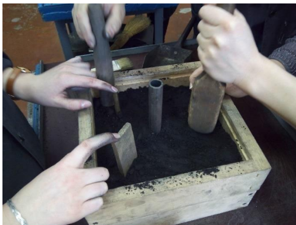
Рисунок 51. Уплотнение трамбовками формовочной смеси.
