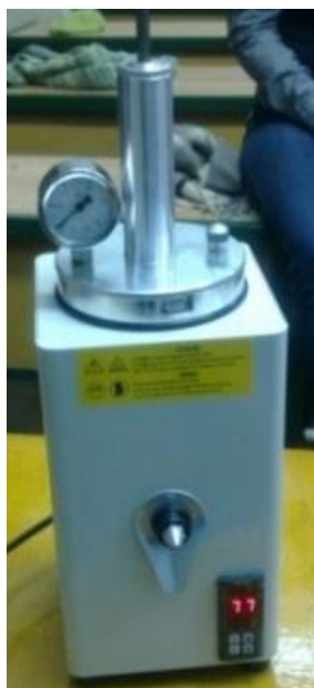
Рисунок 45. Инжектор для изготовления восковых моделей.
