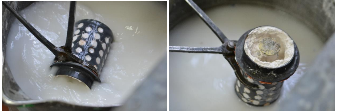
Рисунок 49. Промывка опоки от формовочной смеси.
