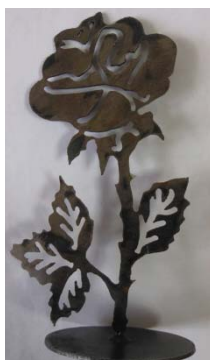
Рис. 5. Полученное плазменно-разделительной резкой изделие
