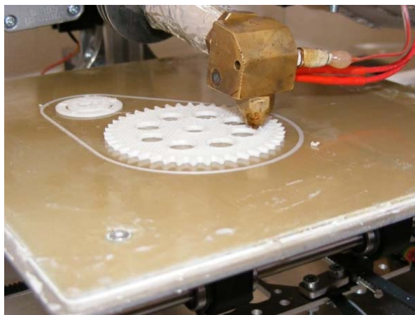
Рис. 3. Создание восковой модели на 3D принтере для воска [4]
