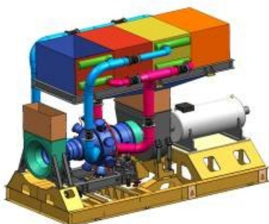
Рисунок 3- Компонка ГТЭ -004 с РВП и турбогенератором (слева) и дополнительно с котлом – утилизатором с габаритами (справа) –
