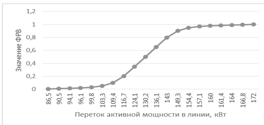
Рис.3. ФРВ перетока активной мощности в линии
