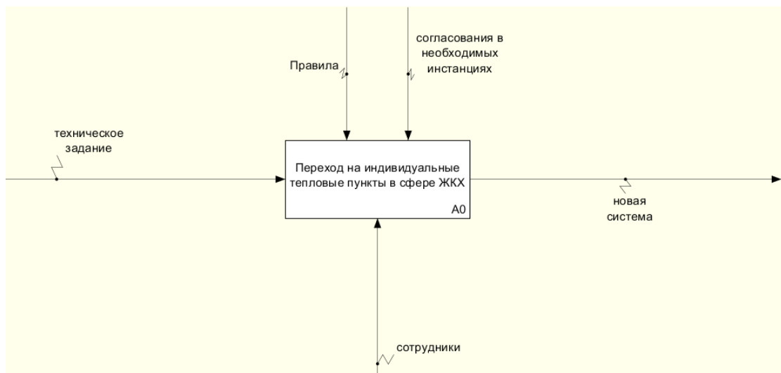
Рис. 2. Концептуальная модель процесса перехода на индивидуальные тепловые пункты (ИТП) в сфере ЖКХ в нотации IDEF0
