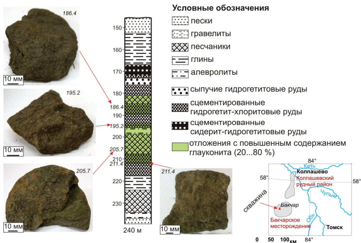
Рис. 2. Схематическая стратиграфическая колонка скважины Бакcharского месторождения и фотографии образцов глауконитовых пород
