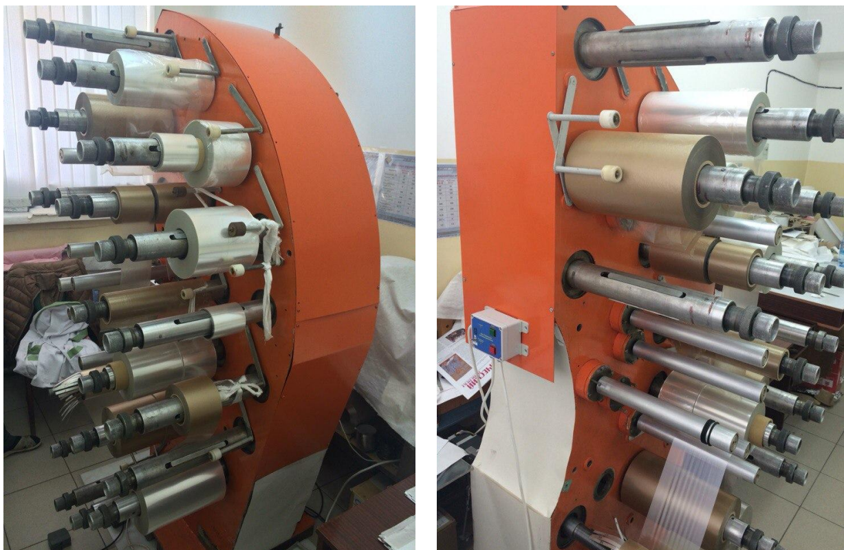
Рисунок 2.3 – Устройство для намотки конденсаторных секций
