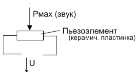
Рисунок 1.2 – Принципиальная схема акустического метода
