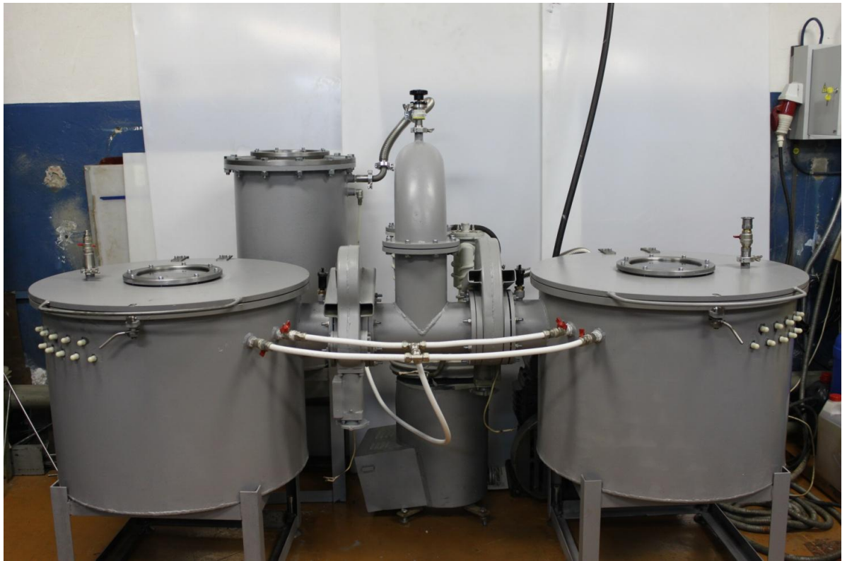
Рисунок 2.4 – Бак для сушки и пропитки секций конденсатора
